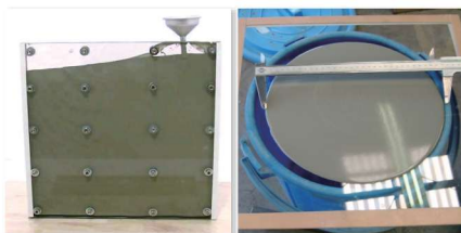
3mm 間隙注入試験 フロー試験 (自己流動試験)
