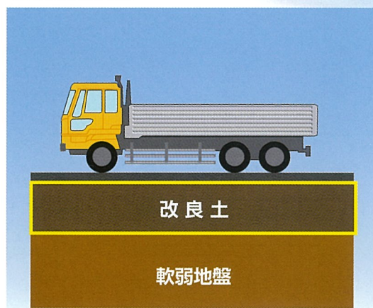
■仮設路床地盤
