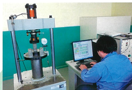
一軸圧縮試験状況
