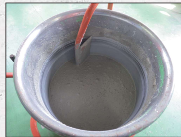
練混ぜ終了。ミキサを停止し、電源を抜いてからご使用下さい。
