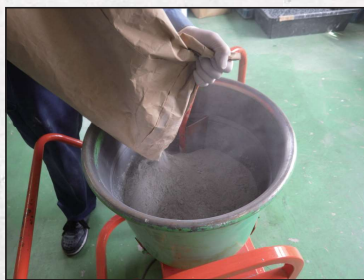
ドラム（練り混ぜ容器）にエスセイバー強を全量投入して下さい。
