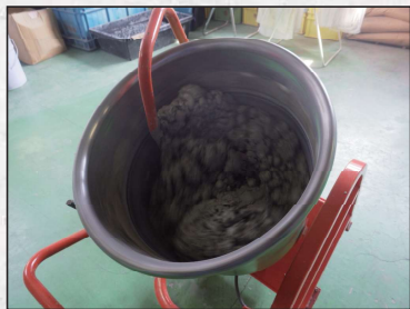
練混ぜ水の投入完了後、所定の時間まで練混ぜを行って下さい。
