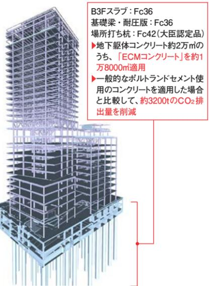
「ECMコンクリート<sup>※2</sup>」を地下躯体の約9割に適用。低発熱性や塩害・化学的浸食による耐久性向上から、耐圧版・基礎や場所打ち杭への適用に向かう
